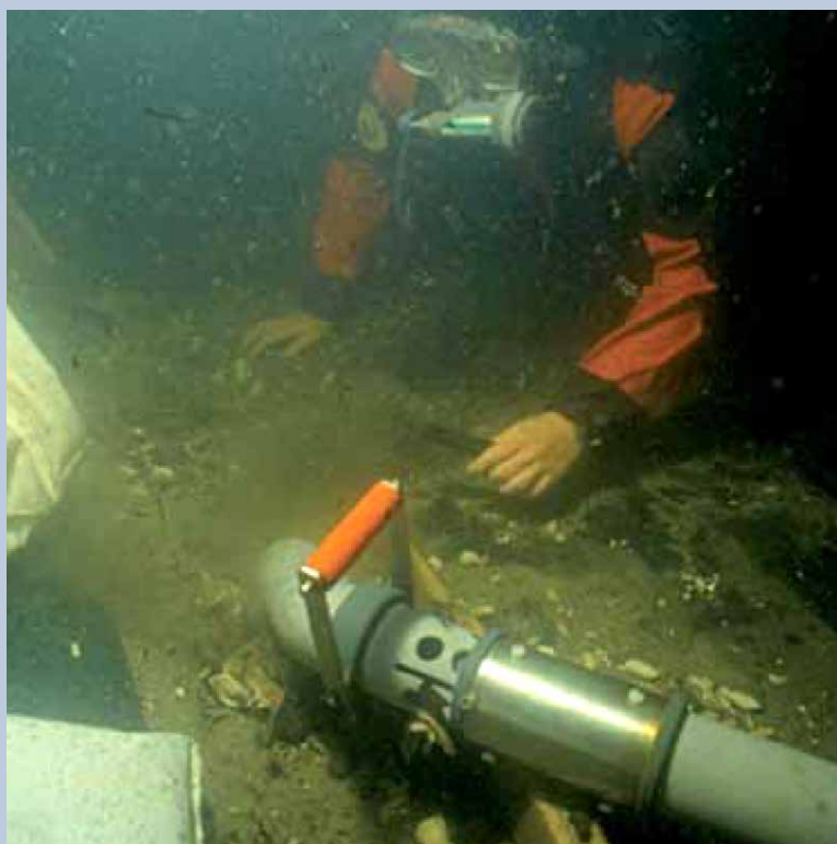
Hoe troebel het water van de Waddenzee ook was, er kon toch onder water worden gefotografeerd. Veel van de apparatuur die het duikteam van het Rijk inzette, werd in eigen huis ontwikkeld. De foto toont een 'airlift' waarmee zand en slib van het 16 e -eeuwse wrak SO1 wordt verwijderd (foto: RCE).
