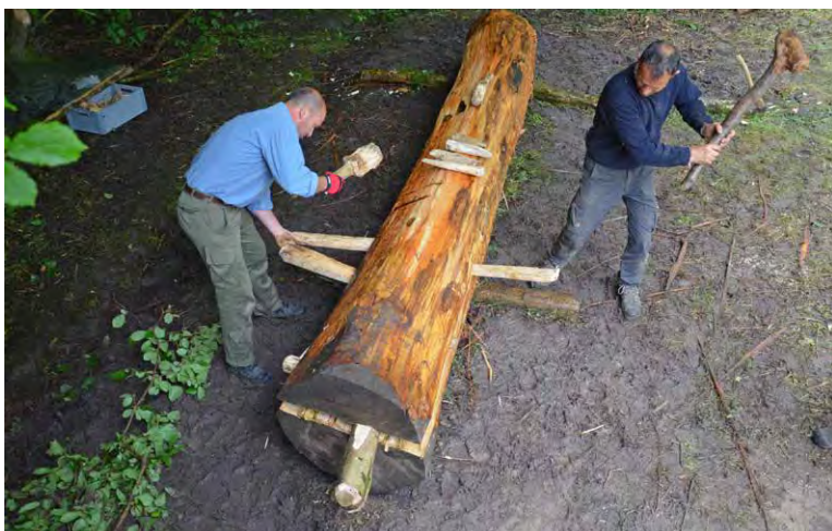
Het afsplijten van de plak, het onderste deel wordt de kano.
