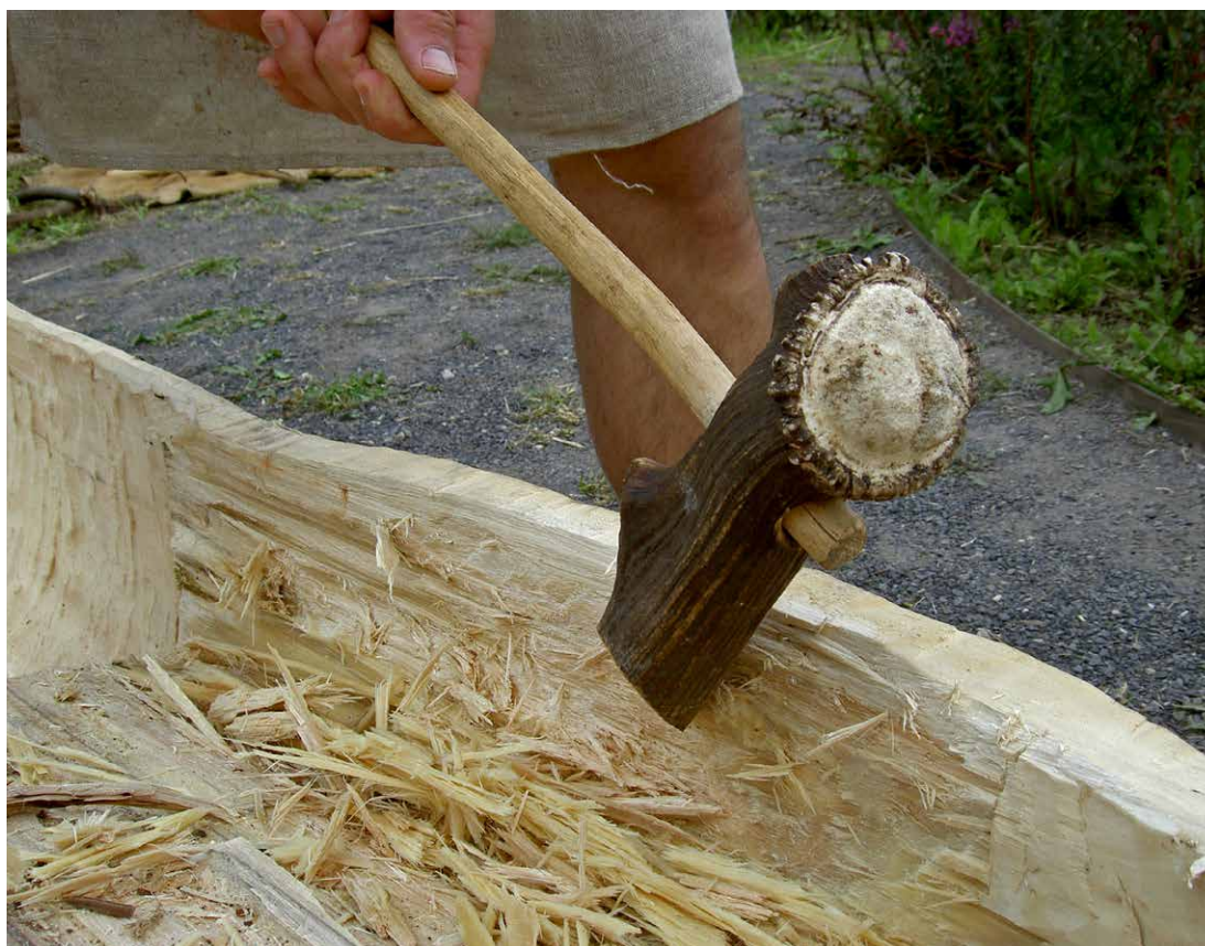
Een geweibijl komt goed van pas bij het uithakken van een boomstamkano.
