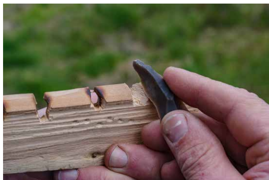
Snijd een inkeping in het plankje die onder breder is dan boven.
