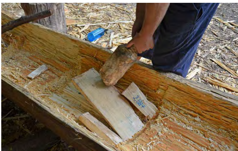
Het afsplijten van een stuk hout met behulp van meerdere wiggen.
