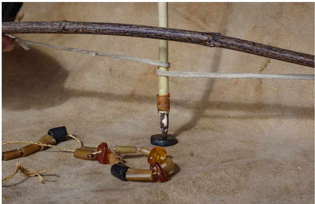
Een kraal doorboren met een boogboor.
