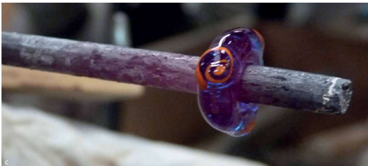
Figure 86 : Réalisation d'un décor de spirale par J. Clesse. a et b. la base conique de la spirale est posée, elle doit être de la même couleur que la perle ; c. et d. un fil de verre jaune est posé autour de cette base conique (e.). Une fois réchauffés, les cônes se rétractent avec les filets ce qui donne des spirales. Le cône peut rester protubérant s'il n'est pas assez réchauffé ou aplati ce qui donne des perles triangulaires ou carrées, et laisse des bosses sur les bracelets du type Haevernick 15.
