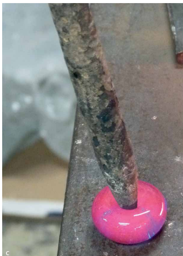
Figure 61 : Percement d'une galette de verre. a. le verre cueilli est modelé pour former une galette à l'extrémité du ferret. b. la galette est détachée du ferret et posée sur une surface plane et propre. Le point d'attache du ferret est encore visible. c. La galette est retournée et le ferret est enfoncé à travers la galette, il la perce. d. la galette est percée.
