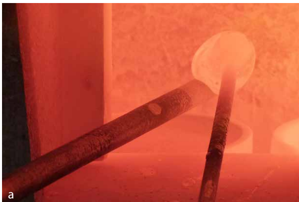
Figure 62 : a. Fabrication d'une perle par enroulement de verre par Guillaume Masclef. b. Détail de l'enroulement. Le verre est soulevé par un crochet et ensuite enroulé sur un ferret.
