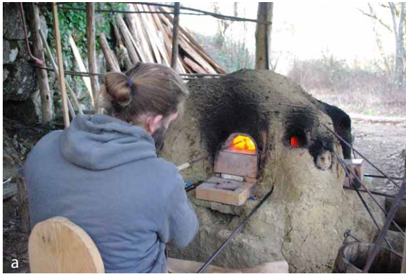
Figure 62 : a. Fabrication d'une perle par enroulement de verre par Guillaume Masclef. b. Détail de l'enroulement. Le verre est soulevé par un crochet et ensuite enroulé sur un ferret.
