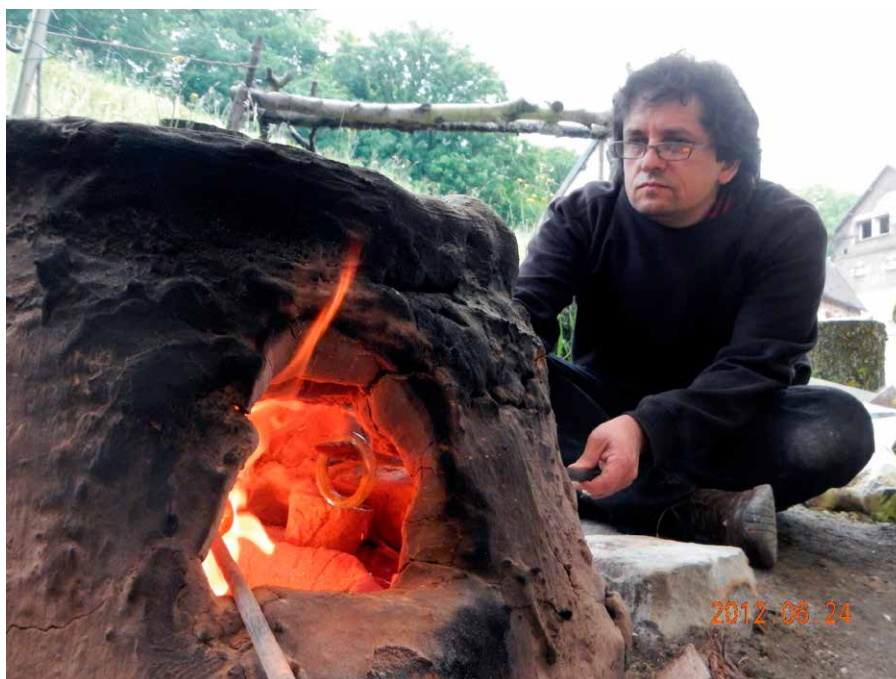
Figure 103 : Photos de fabrication de bracelets sur le deuxième four construit à la citadelle d'Amiens. En bas, au premier plan, on aperçoit à travers l'un des ouvrages l'intérieur du four. Un creuset repose sur la margelle.
