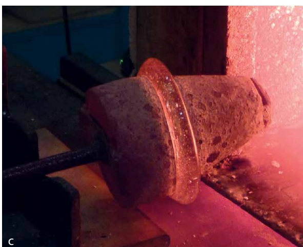
Figure 73 : Reprise au cône d'une perle en cours d'agrandissement. a. La perle est placée à l'extrémité d'un cône, ici en métal. b et c : La rotation du cône permet de faire remonter le bracelet le long de celui-ci jusqu'à son diamètre final.
