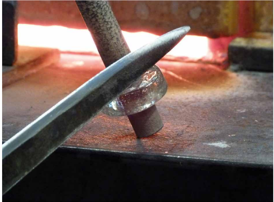
Figure 66 : Cette intervention avec un outil sur la perle en verre peut aider à la décoller. Elle peut aussi laisser des traces sur la perle.
