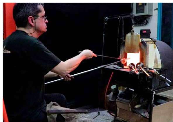
Figure 50 : Production de bracelets en verre dans l'atelier de Silicybine, sur l'un des deux fours à gaz adaptés à une position de travail assise. Ce four a été fabriqué pour réaliser principalement des bracelets. Sa petite taille et ses petits creusets permettent un travail plus près de l'ouvrage.
