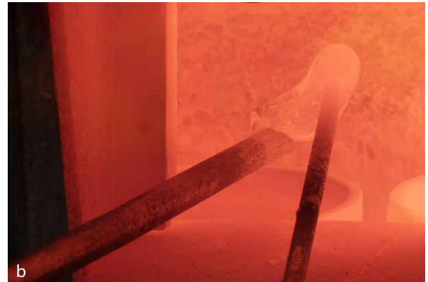
Figure 62 : a. Fabrication d'une perle par enroulement de verre par Guillaume Masclef. b. Détail de l'enroulement. Le verre est soulevé par un crochet et ensuite enroulé sur un ferret.
