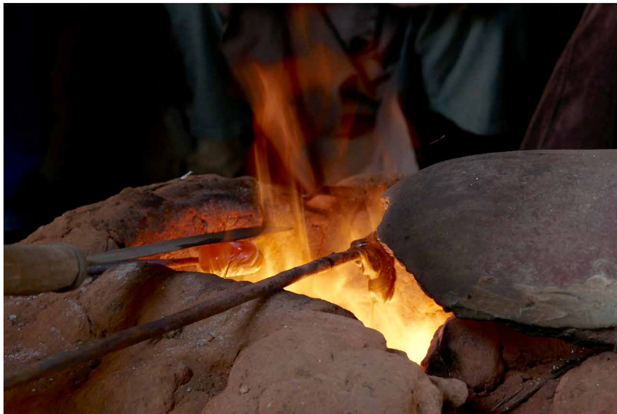
Figure 100 : Atelier de Bida : verre ramollissant au-dessus du four. Photo Lesley Lababidi 2015.
