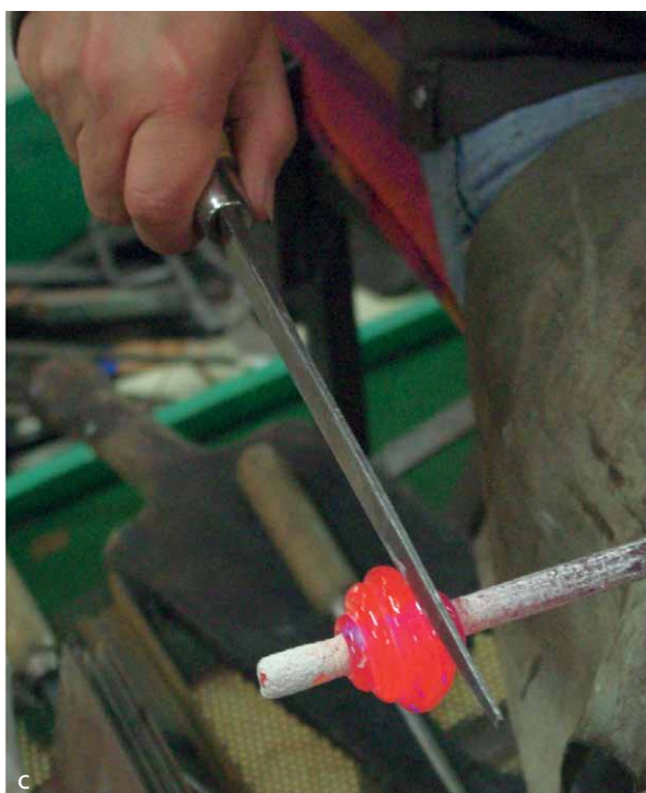
Figure 77 : Photos (a à c) et schéma (d) de l'impression des côtes parallèles sur la perle avant son agrandissement. En e, les côtes sont de nouveau marquées alors que la perle a déjà été agrandie. Le ferret sert alors de point de résistance à la pression exercée sur le verre.
