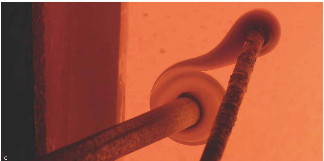
Figure 63 : Fabrication d'une perle de verre par l'enroulement d'un cordon. a. Le verre prélevé dans les creusets, visibles à l'arrière-plan, est collé à un second ferret. b. Ce second ferret est mis en rotation (ici dans le sens inverse des aiguilles d'une montre). c. Le verre s'enroule autour du ferret et forme une perle.
