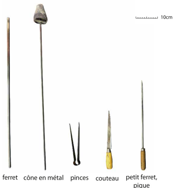
Figure 106 : Kit d'outils développés pour la mise en forme des bracelets celtiques en expérimentation. Des ferrets supplémentaires peuvent être utilisés pour les décors et une grande pince pour mettre le verre dans les creusets.
