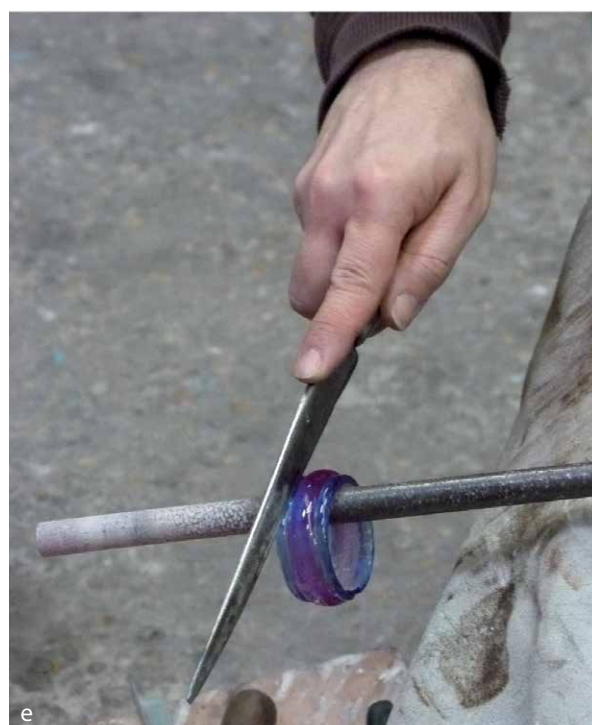
Figure 77 : Photos (a à c) et schéma (d) de l'impression des côtes parallèles sur la perle avant son agrandissement. En e, les côtes sont de nouveau marquées alors que la perle a déjà été agrandie. Le ferret sert alors de point de résistance à la pression exercée sur le verre.
