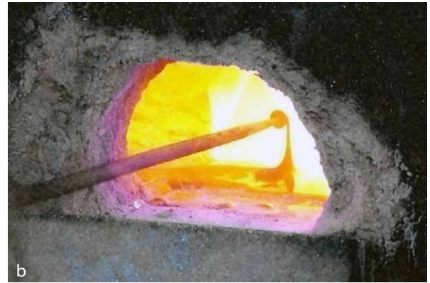
Figure 62 : a. Fabrication d'une perle par enroulement de verre par Guillaume Masclef. b. Détail de l'enroulement. Le verre est soulevé par un crochet et ensuite enroulé sur un ferret.
