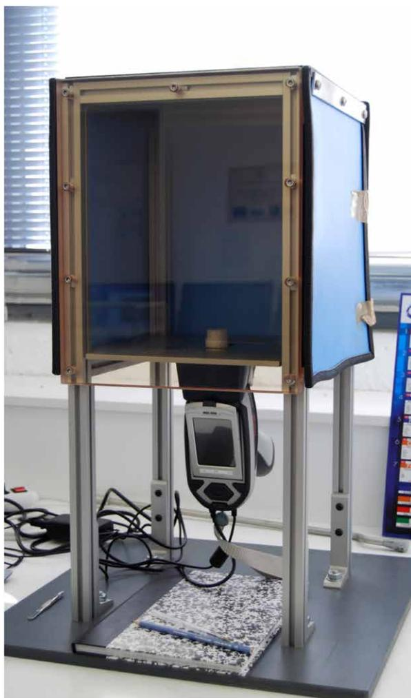
Fig. 22 : Spectromètre portable de fluorescence des rayons X et sa chambre de confinement (P-XRF).
