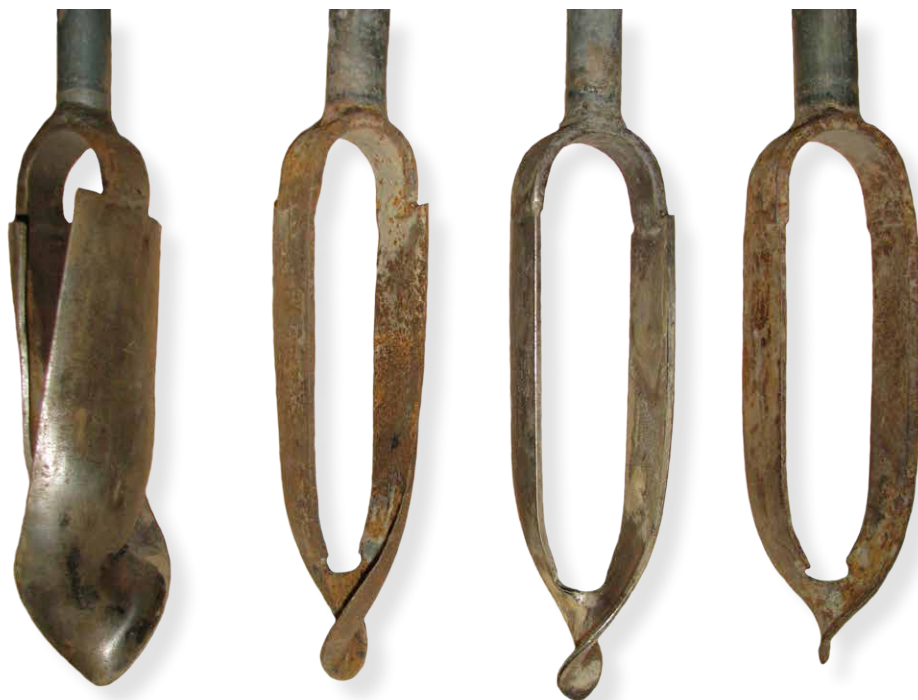
Afbeelding 9.01: Van rechts naar links kleiboor, combiboor, zandboor en grof zandboor.
