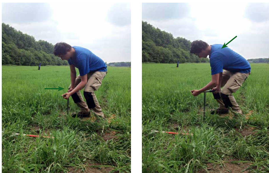
Afbeelding 9.07: Het indraaien van de boor levert over het algemeen een ongelijke belasting.
