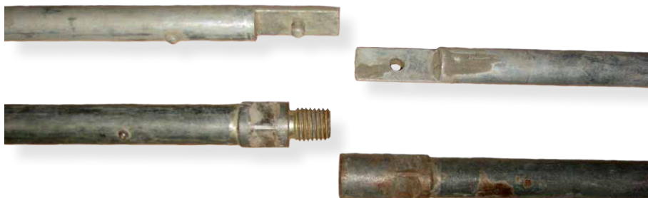
Afbeelding 9.02: Boven bajonetsluiting; onder conische draadsluiting.
