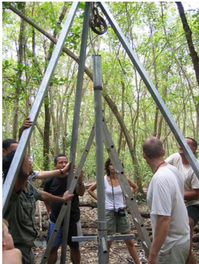
*Figure 3 : Extraction du prélèvement du carottier.*
