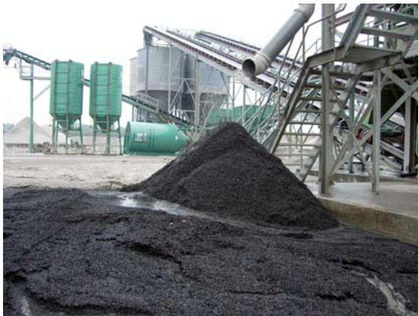
Fig. 5 De plek op het bedrijfsterrein van REKO Grondverzet en Wegenbouw bedrijf Raalte B.V. waar de middelste fractie van het organische ma- teriaal (tot ca. 5 mm) uit het grind en zand wordt gesorteerd (10 oktober 2006)
