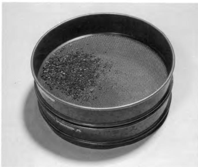
Fig. 17 Schlämmrückstand der fertig geschlämmten Probe.
