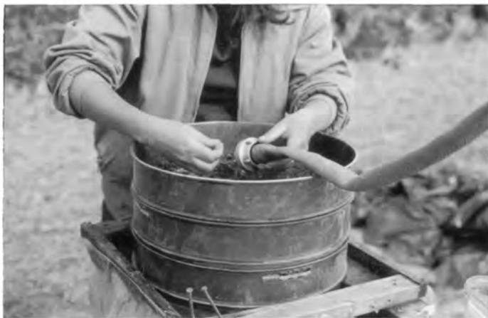
Fig. 15 Schlämmen von botanischen Bodenproben mit einem Siebsatz von 1, 0,5 und 0,25 mm Maschenweite.
